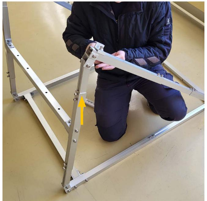
Prüfen der Länge und schrauben festziehen (16cm für Solarmodul EAS-S410)
