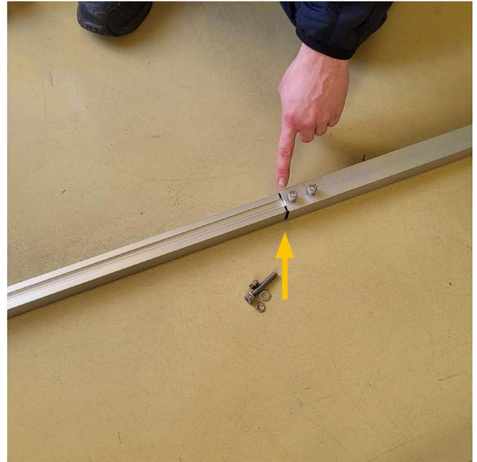
Anstellwinkel entsprechend der Kennzeichnung ausrichten
