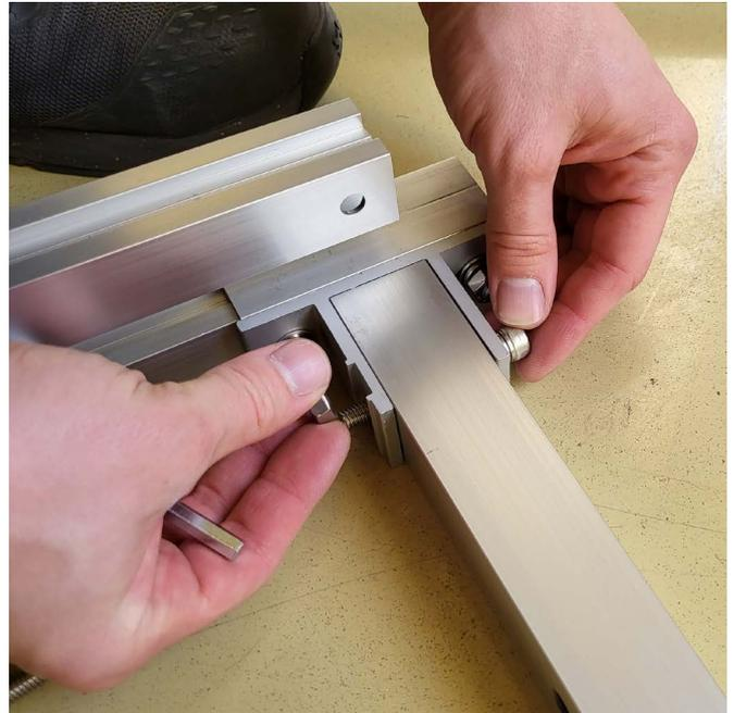
Mutter auf Seite der Rippen einsetzen (Mutter verkantet dadurch selbst)
