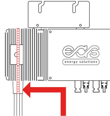
Die Kabelbinder-Sicherung erst **NACH** der Installation durchtrennen.
